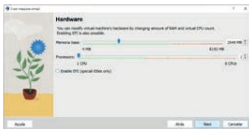
Especificación de prestaciones durante la creación de una máquina virtual en VirtualBox.
