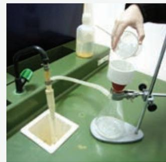
Figura 7.24. Montaje de una filtración al vacío.
