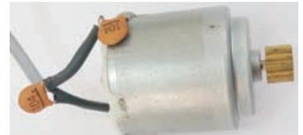
Los condensadores se emplean para filtrar señales indeseadas generadas por los motores.
