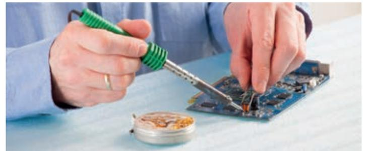
1. Se calientan los cables y los extremos de los componentes con el soldador hasta que alcancen la temperatura necesaria.
