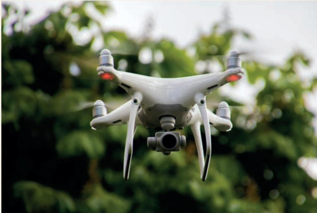
Los drones incluyen GPS y un altímetro para conocer la posición y altura. Los sistemas electrónicos de control utilizan estos datos para realizar navegación autónoma y sistemas de seguimiento de un objetivo en los que el dron graba los movimientos de un objeto o ser vivo.
